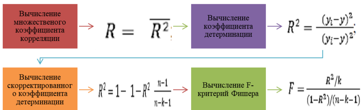
Рисунок 2. Алгоритм практического применения многофакторного корреляционного регрессионного анализа в задаче оценки стоимости жилья
