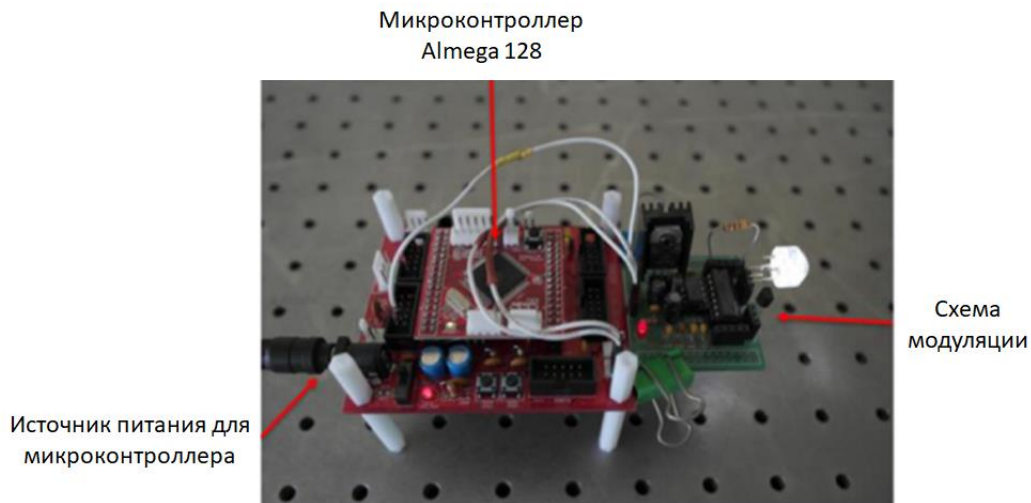
Рисунок 2 – Передающий модуль с использованием системы VLC
